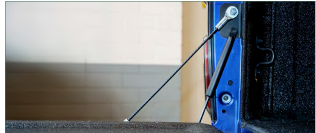
SPOUŠTĚCÍ A ZVEDACÍ POMŮCKA PRO ZADNÍ VÍKO Usnadňuje otevírání a zavírání víka zavazadlového prostoru těžkého vozidla
